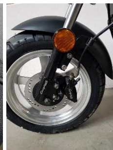
geveerde voorvork met schijfrem
